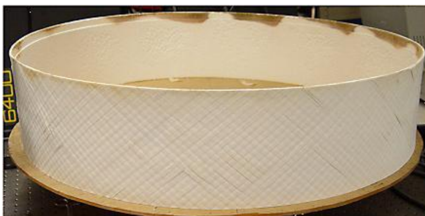
شکل ۵- لاینر محفظه احتراق از جنس کامپوزیت سرامیکی
