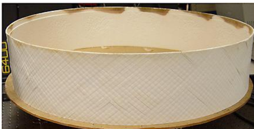
شکل (۷-۱) لاینر محفظه احتراق از جنس کامپوزیت سرامیکی
