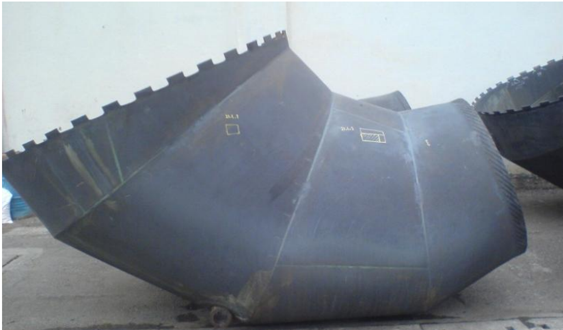
شکل ۱۰- نمای ظاهری میکسینگ چمبر
